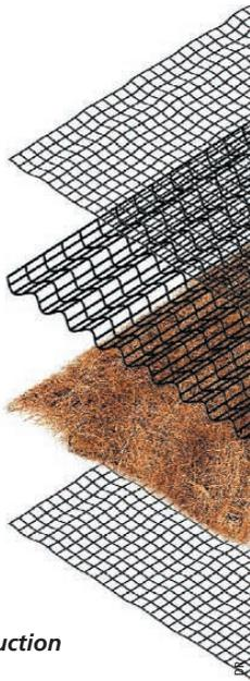
Pour la réalisation des cunettes ou pour la protection contre l'érosion des talus et des berges, ces nouvelles géogrilles (géomats) à haute résistance comprennent un remplissage de fibres de coco (C350) ou de polypropylène vert (P550) qui évite l'usage de terre et les rend immédiatement efficaces même avec de très fortes sollicitations (576 N/m<sup>2</sup> ou vitesse jusqu'à 7,6 m/s).
